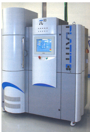
Obr. 11: Povlakovací zařízení pro vytváření tenkých vrstev metodou PVD (výrobce: PIVOT a.s., Šumperk)
