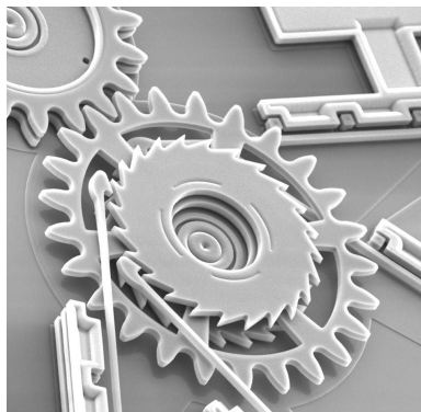
Obr. 2: Část mikroelektromechanického systému (MEMS). Rohatkový systém vyrobený pětiúrovňovou technologií. (MEMX, Ltd. , Santa Clara, Ca., USA)
