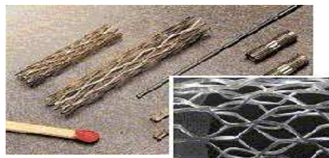
Obr. 12: Laserem vyrobený koronární stent s detailním pohledem (Forschungszentrum Karlsruhe, Německo)
