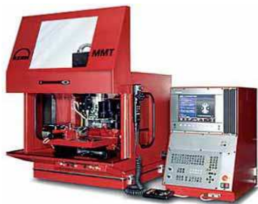
Obr. 3: Stolní mikrofrézovací a mikrovrtací zařízení 5 . Schopnost rozlišení-100nm, pracovní přesnost-2,5μm, přesnost polohování-1μm (Kern Micro-und Feinmechanik GmbH & Co.KG.Murnau)
